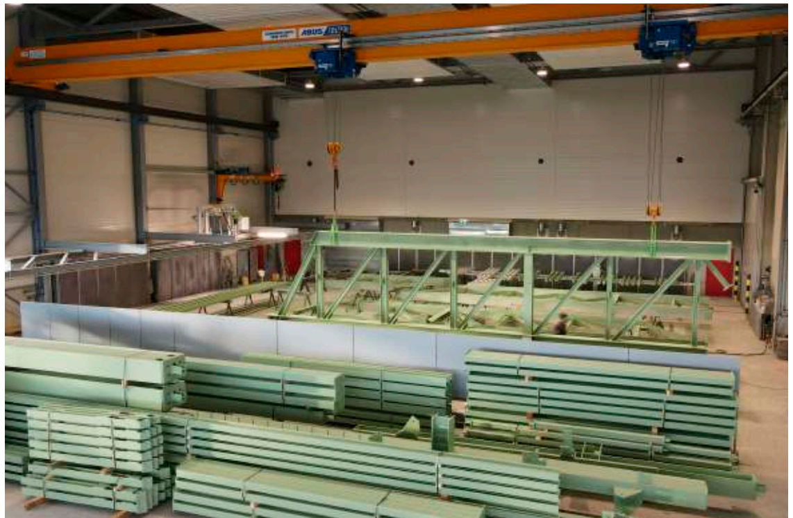
Die neue Lackierhalle mit angeschlossenem Kommissionier- und Auslieferungslager der Firma Stahlbau Grabner in Hartberg ermöglicht eine Steigerung des Bauteiledurchflusses und erhöht die Qualität der Lackierung. Stahlbau Grabner
